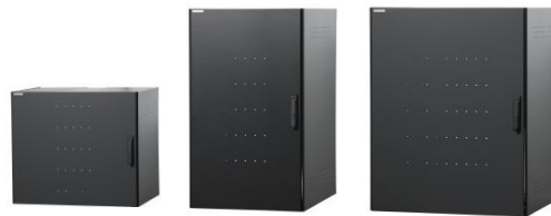
Ekstra store: 15 eller 22HE, dybde 800, med 19" i front og bag: Leveres i bredde 600 og 800. Bredde 800 er forberedt for fingerkabelmanagement.
